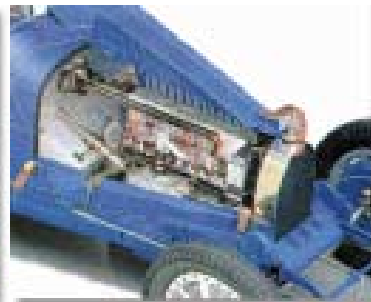
2,3-литровый 8-цилиндровый рядный двигатель с верхним распределительным валом и роторным нагнетателем Bugatti 35B мощностью 135 л.с. (1927 г.)
