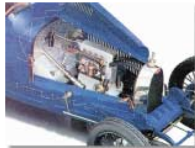
1,5-литровый 4-цилиндровый рядный двигатель Bugatti 37 (1926 г.)
