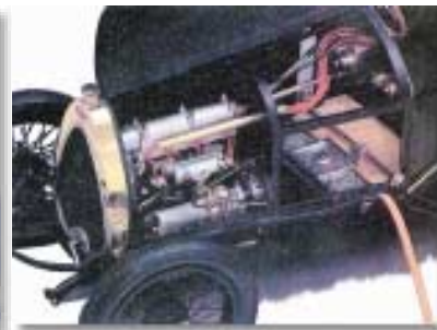
1,5-литровый 4-цилиндровый 16-клапанный рядный двигатель с двумя верхними распределительными валами Bugatti 13 Brescia мощностью 40 л.с. (1921 г.)
